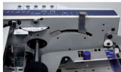
TF MEGA-A: Justierung von Blattanpressdruck und -separierung für unterschiedliche Papierstärken
