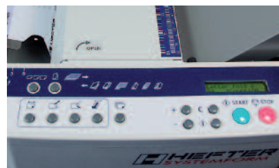
TF MEGA-A: Übersichtliches Bedientableau mit Display, Job- und Vorwahlzähler
