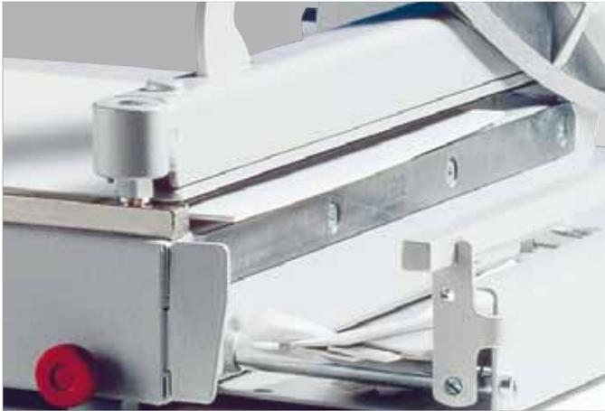
**VORDERANSCHLAG** Der Vorderanschlag mit Schmalschnitteinrichtung lässt sich über einen Skalen-Drehknopf millimetergenau einstellen.
