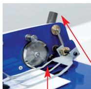
Starke, selbstschärfende Stahlmesser. Schnittbreite variabel einstellbar.
