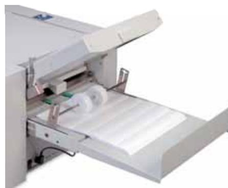
Stets saubere Ablage der gefalzten Bogen durch die automatische Justierung der Schuppenablage in Abhängigkeit von Papierformat und Falzart.
