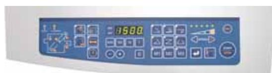
Großes und übersichtlich strukturiertes Bedientableau mit digitalem Display. Per Tastendruck stellt sich die Falzmaschine auch automatisch auf individuelle Falzapplikationen ein, die in den Jobspeichern hinterlegt wurden.
